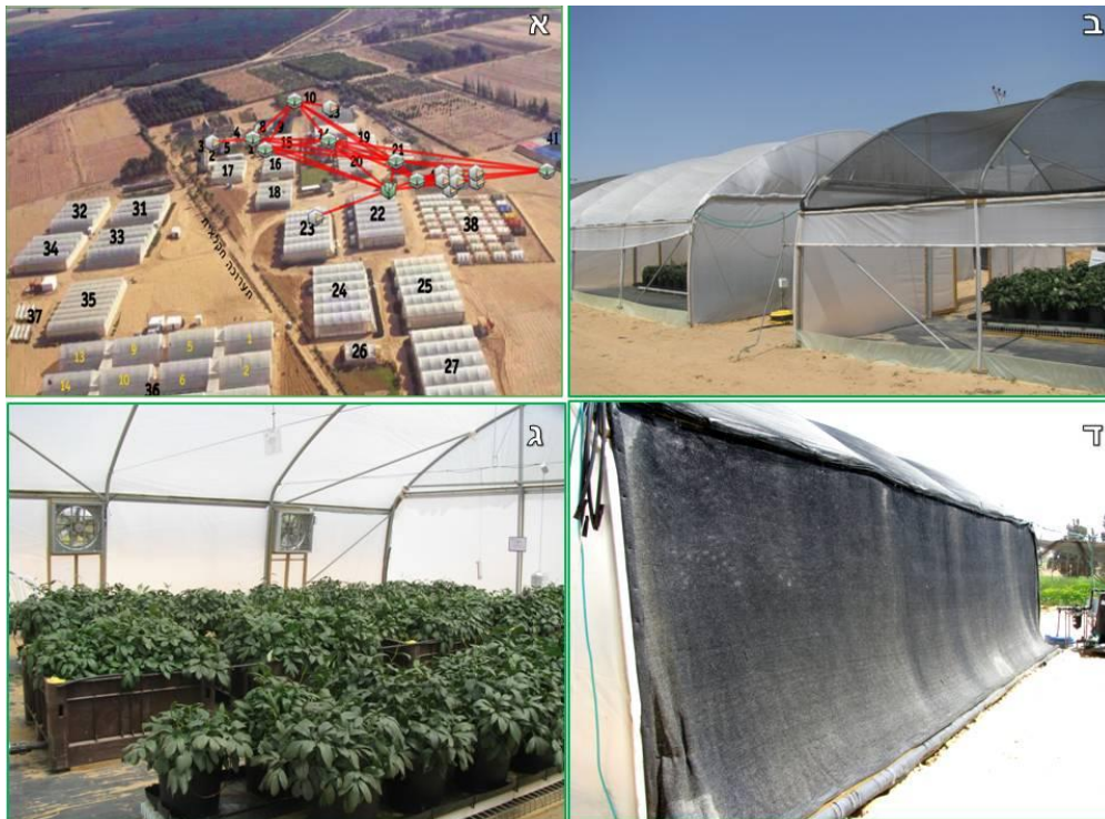
איור 13 מערכת ניסוי לגידול צמחי אדמונית בתנאים חצי-מבוקרים א. פריסה אלחוטית של חיישנים במו"פ דרום, ב. מנהרות עם כיסוי רשתות בלבד – "צינור פסיבי", ג. מראה של תוך המבנה המצונן, ד. רשת מורטבת על דופן המבנה.
